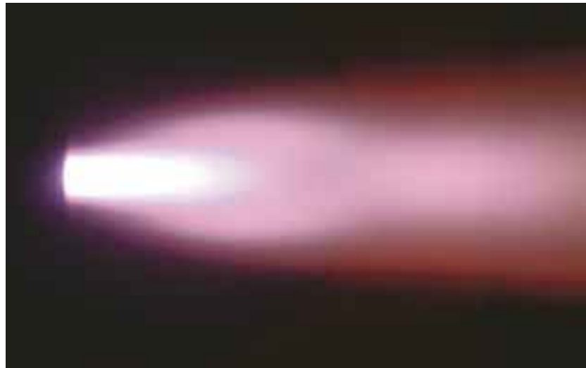
Jet supersonique raréfié de plasma obtenu à partir d'argon dans la soufflerie PHEDRA (4,5 kW, v = 4 km/s). La couleur rouge renseigne sur la pénétration du gaz résiduel à l'intérieur de l'écoulement plasma.
