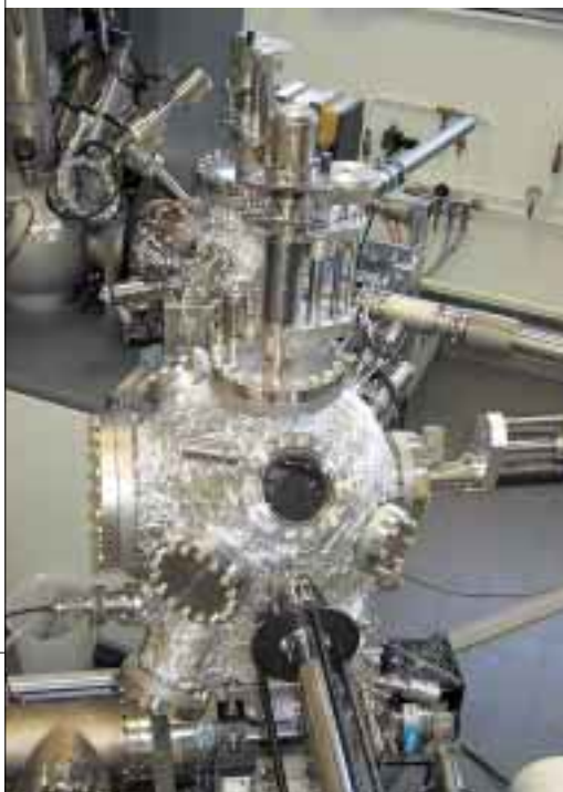
Système de dépôt d'atomes sous ultra vide assisté par faisceau d'ions
