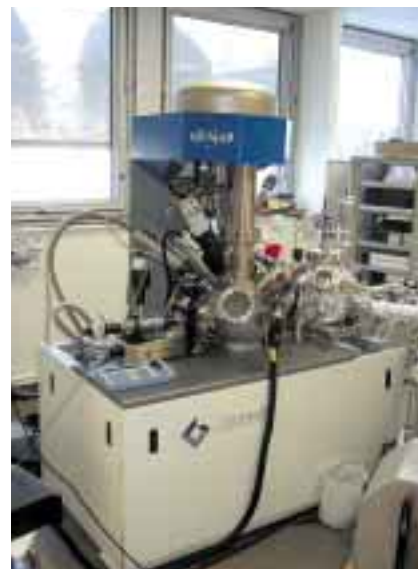
Spectromètre de photoélectrons XPS et UPS.
