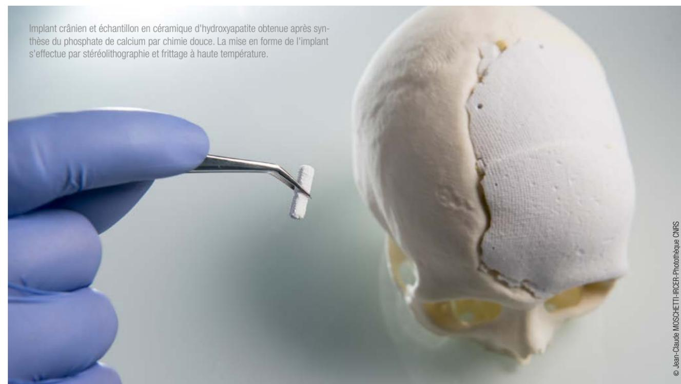
Implant crânien et échantillon en céramique d'hydroxyapatite obtenue après synthèse du phosphate de calcium par chimie douce. La mise en forme de l'implant s'effectue par stéréolithographie et frittage à haute température.
