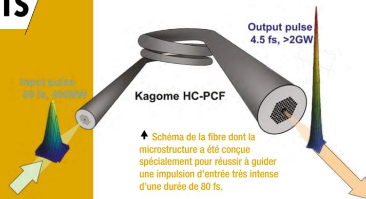
↑ Schéma de la fibre dont la microstructure a été conçue spécialement pour réussir à guider une impulsion d'entrée très intense d'une durée de 80 fs.
