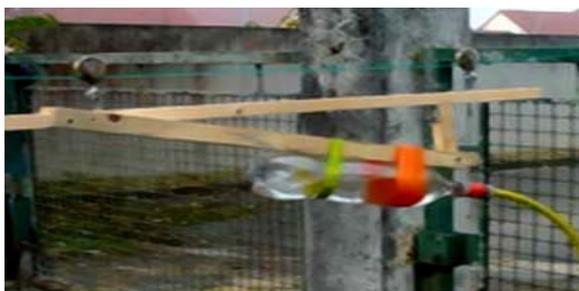
Nous avons eu l'idée de fixer notre bouteille sur un **téléphérique**. Dans un premier temps, nous l'avons construit en bois, avec des poulies métalliques pour rouler sur notre câble de 60m. Nous avons testé les quantités d'eau et de pressions nécessaires pour optimiser la propulsion (quelle que soit la pression, le volume d'eau doit être égal à environ 60% du volume total).
