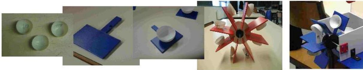
On découpe dans une matière plastique une plaque bleue pour le fond du bateau, on plie une plaque plastique pour fixer la turbine et on fixe une autre plaque pour placer la bouteille d'eau.
