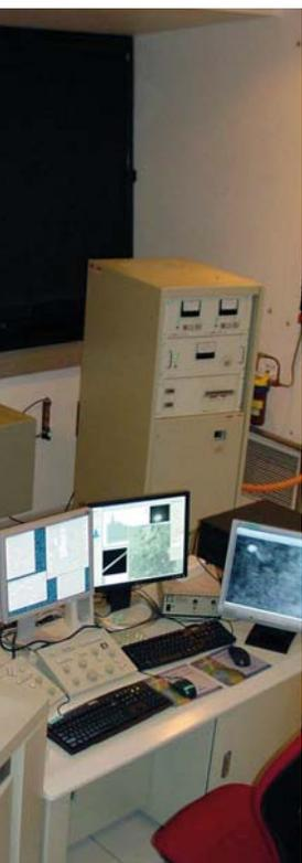
Microscope électronique en transmission, de 200 kV à canon à émission de champ, équipé HAADS et EELS.
