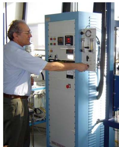
Presse haute température utilisée par S'TILE pour réaliser des plaquettes de silicium polycristallines.
