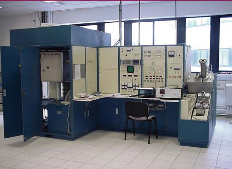
Implanteur ionique de 200 kV
