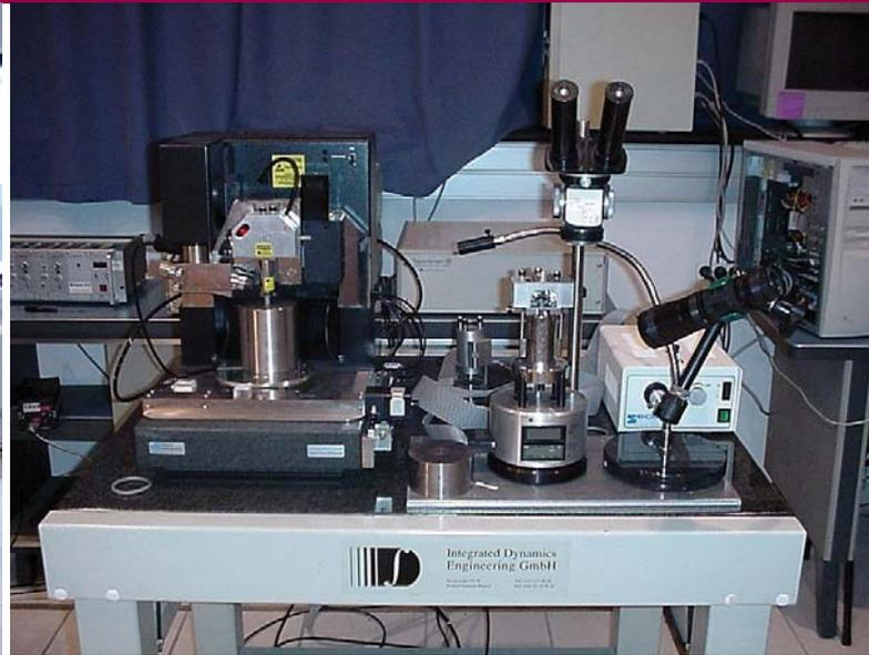
Dispositif de sollicitation mécanique sous microscope à champ proche (AFM).
