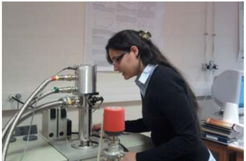
Cryocooler ou « super-réfrigérateur » permettant de refroidir les supraconducteurs à haute  $T_c$  jusqu'à 6 K et mesurer leurs propriétés optiques dans le visible et l'infrarouge, en particulier au voisinage de la température critique.
