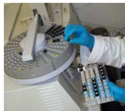
Passage d'échantillons pour analyse physico-chimiques en spectrométrie de masse.
