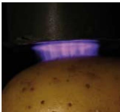
Plasma d'air créé par une DBD Flottante (17kW/100Hz) actuellement utilisé pour des traitements de tumeurs sous-cutanées (photo GREMI).
