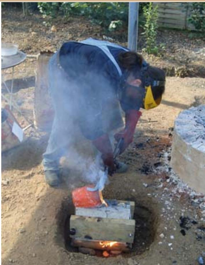
*Coulée de laiton sur la plate-forme expérimentale du site des Mines d'Argent des Rois Francs à Melle (Deux-Sèvres)*
